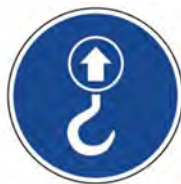
64620 – lyftpunkt (modulerna B, C och D)
